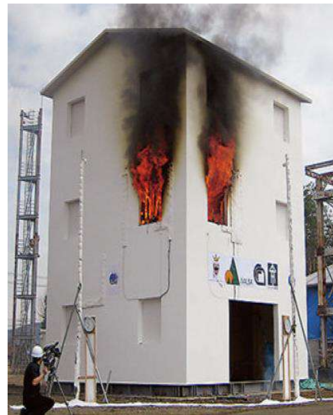
つくばで行われたCLT耐火実験
