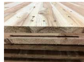
工場でプレカット 現場では組立のみ
